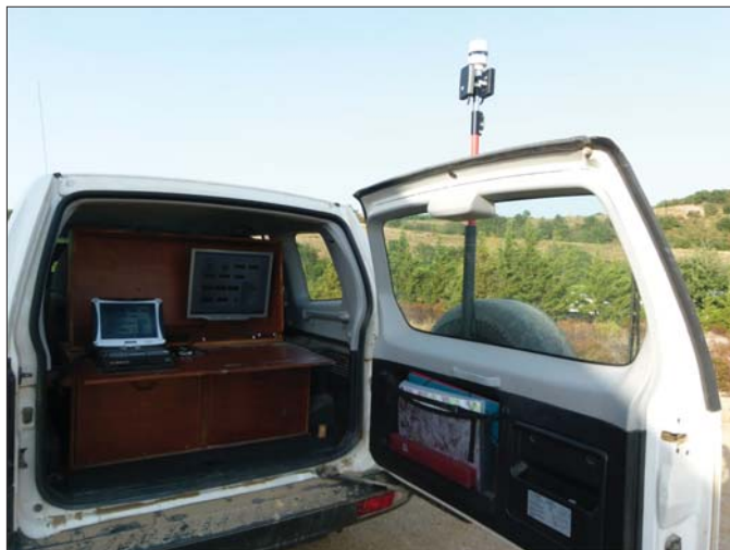
Exemple de station météorologique embarquée (cellule REX66)
