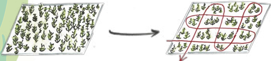
SFOLLI RETICOLARI. IN ROSSO, I PRINCIPI DI CIRCOLAZIONE DELLA MACCHINA
