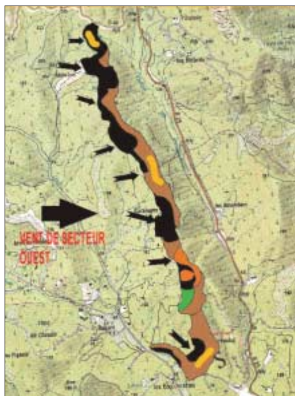
Carte 2 : Résultats d'une simulation Optiflow sur la coupure de combustible de Catalugno : la direction locale du vent (petites flèches) est déduite à partir de celle du vent synoptique simulé (grosse flèche)
